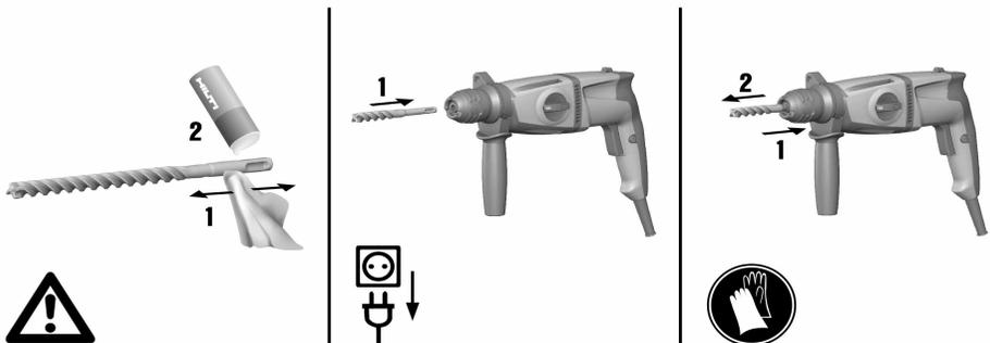
► Setzen Sie das Werkzeug in die SDS Werkzeugaufnahme ein / nehmen Sie das Werkzeug aus der SDS Werkzeugaufnahme heraus.
