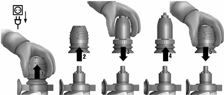
► Montieren / demontieren Sie die Werkzeugaufnahme.
